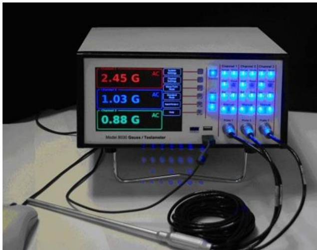
Meranie v exteriéri Gauss/Teslameter Model 8030 (vľavo) s externou sondou (vpravo)
