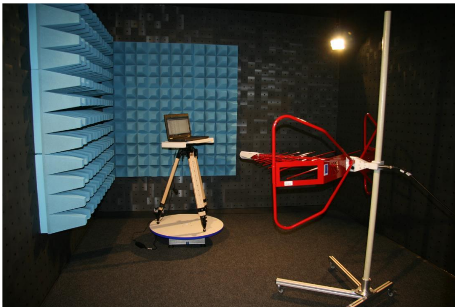
Meranie elektromagnetickej kompatibility elektronických zariadení v bezodrazovej komore
